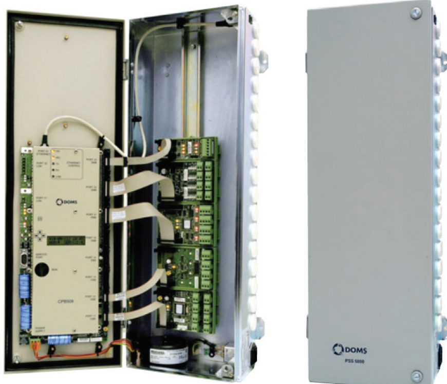
Блок контроллера PSS 5000 в открытом (слева) и в закрытом (справа) виде. Плата центрального процессора и модули интерфейсов смонтированы внутри корпуса контроллера, где происходит подключение СУ к оборудованию АЗС.
